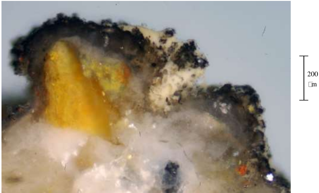
Foto n. 38. La foto riprende l’irregolare crosta nera superficiale a base di gesso, particelle carboniose e ossidi di ferro. Sezione Lucida, Luce riflessa, 100 X, N//
