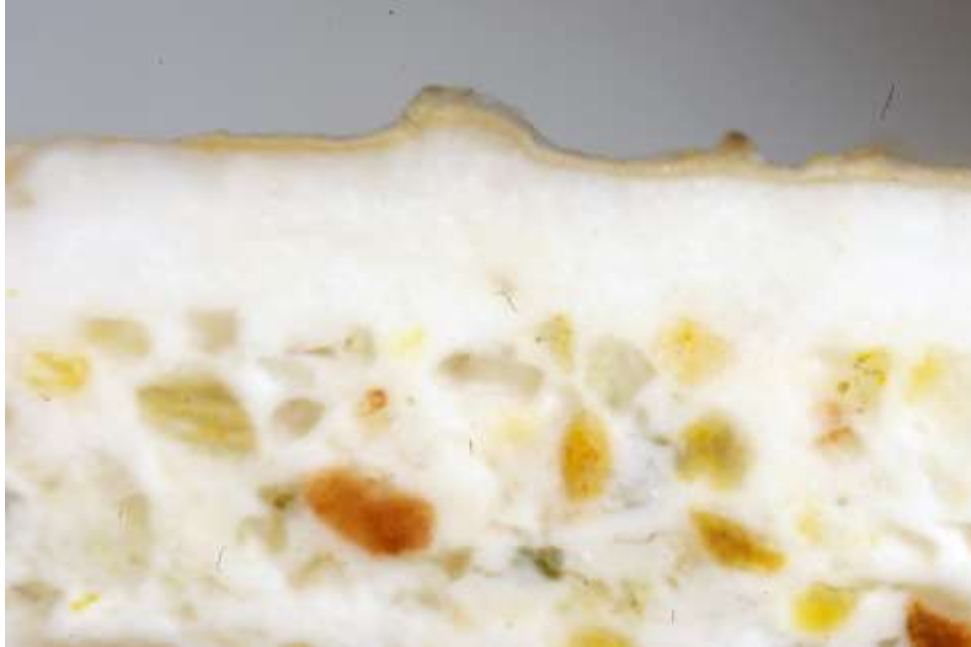
Foto n. 19. Sezione lucida del campione in cui si possono osservare le stesure che caratterizzano il frammento in studio. Luce riflessa, 40 X, N//
