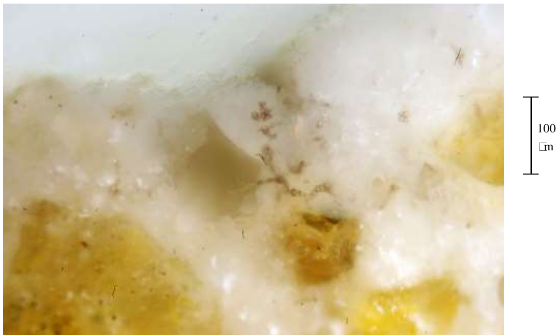
Foto n. 48. Particolare ingrandito dove si osservano alcune colonie brunastre attribuibili a muffe. Sezione Lucida, Luce riflessa, 200 X, N//
