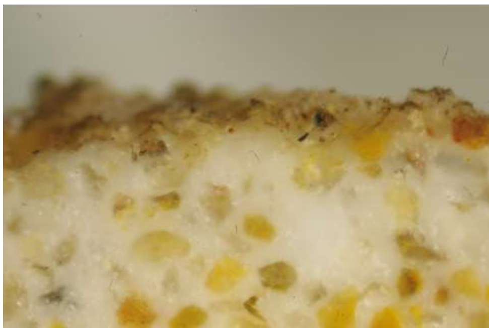
Foto n. 61. La foto riprende una zona superficiale dove la matrice carbonatica, fortemente solforata, presenta una concentrazione di ossidi di ferro idrati provenienti in seguito a migrazione da una zona di intonaco più profonda. Sezione Lucida, Luce riflessa, 40 X, N//
