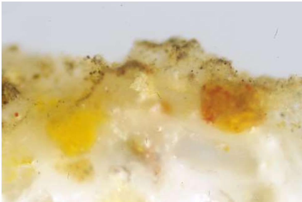
Foto n. 62. Dettaglio ingrandito della zona superficiale dove sono ben visibili le concentrazioni degli ossidi di ferro idrati (di tipo limonitico). Sezione Lucida, Luce riflessa, 100 X, N//
