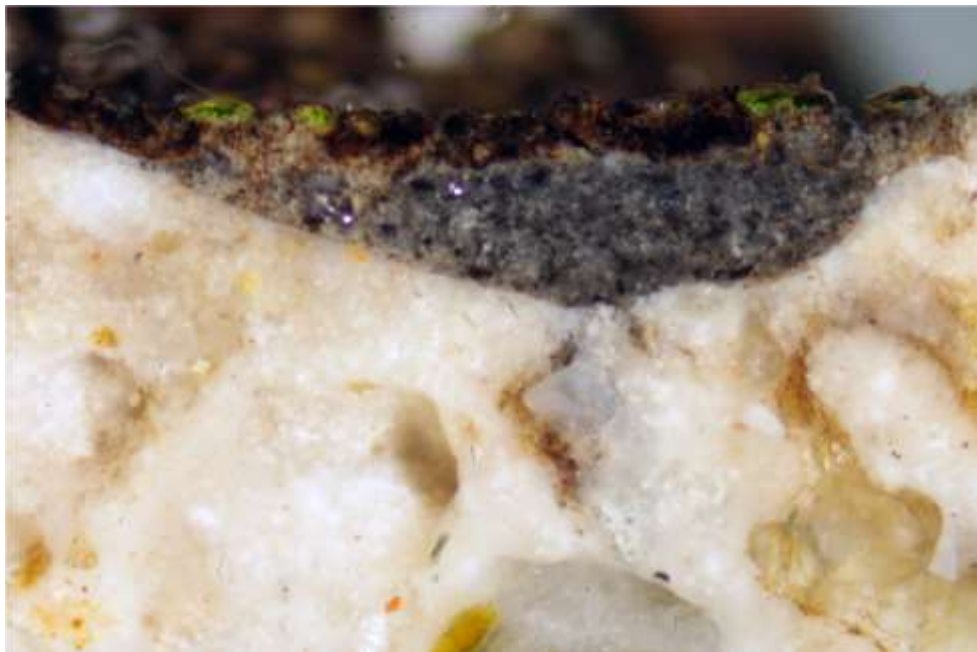
Foto n. 12. La foto evidenzia l'irregolare strato superficiale di crosta nera che ricopre l'intonaco e la formazione di licheni superficiale. Sezione Lucida, Luce riflessa, 40 X, N//
