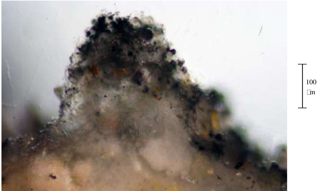
Foto n. 39. Particolare ingrandito per cui si possono apprezzare molto bene le caratteristiche morfologiche e cromatiche della crosta nera. Sezione Lucida, Luce riflessa, 200 X, N//
